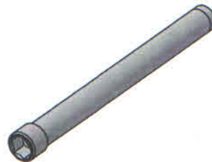
Chave sextavada de 1" com encaixe quadrado de 1/2 para porca de encolhedores de molas tipo gancho (somente para encolhedor com porca de 1")
