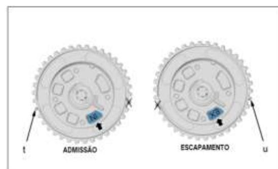
Alinhar a marca na correia de distribuição (n) com a marca do defasador do comando de válvulas de admissão (t). Posicionar o defasador de eixo de cames de admissão (14) sobre o comando (v).
