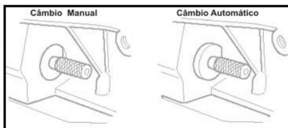
A colocação dos pinos determina o correto alinhamento dos pistões em ponto de PMS. Ao posicionar a árvore de manivelas, as polias da árvore do comando de válvulas também deverão estar alinhadas com o cabeçote. Se isso não acontecer, de mais uma volta na árvore de manivelas.
