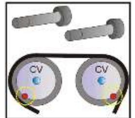
Afrouxe o parafuso central da árvore de manivelas (sem removê-lo). Após afrouxar o parafuso central, a polia dentada permitirá um pequeno giro livre para ambos os lados. Esse giro será necessário para distribuir a tensão na montagem da correia nova.
