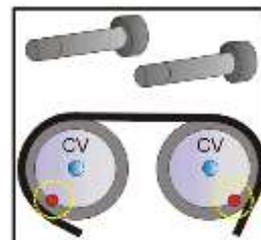
Nesse modelo de motor, após 2003 a polia tem amortecimento de vibração, é uma peça inteira que terá que ser removida. Após a remoção, já se vê a polia dentada e ao soltar seu parafuso central, ela permitirá um pequeno giro livre para ambos os lados. Esse giro será necessário para distribuir a tensão na montagem da correia nova.
