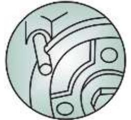
Recoloque a ferramenta 12122 para travar o volante do motor.
