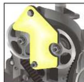
Remova a ferramenta 14311 e reinstale a capa plástica da correia dentada. Reinstale a polia da árvore de manivelas e aperte o novo parafuso manualmente. Depois aplique torque 25Nm + 135°.
