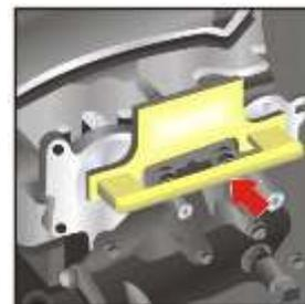
Nos veículos de transmissão manual, retire o sensor de rotação e instale no lugar deste a ferramenta 14310. Nos veículos com transmissão automática remova o motor de partida e instale em seu lugar a ferramenta 12122.
