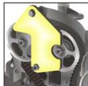
**IMPORTANTE:** Nunca afrouxe ou aperte o parafuso de fixação das polias do comando de válvulas sem travá-la com a ferramenta 14311, pois isso pode danificar a ferramenta 14309.
