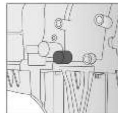
Gire lentamente a árvore de manivelas até ela parar e instale as ferramentas de alinhamento do comando de válvulas 12108, caso as ferramentas não se encaixem, repita o procedimento.
