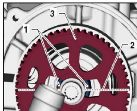
Instale o posicionador 10052 (aplicado nos motores 1.0 12V MPI e 1.6 16V MSI) ou 10055 (aplicado nos motores 1.0 12V TSI e 1.4 16V TSI/TFSI) na árvore de comando das válvulas de admissão até o batente e aperte levemente com o parafuso conforme a seta na imagem ao lado.
